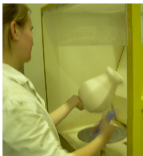
Emaillage au pistolet d'une pièce avant cuisson
